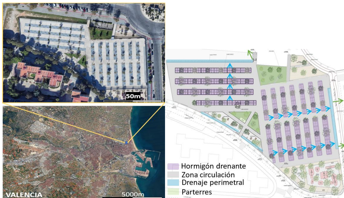
Figura 1 | Zona de estudio. Superior: Localización y distribución de la zona de estudio. Inferior: Detalle encuentro hormigón poroso-alcorque, tubo drenaje del pavimento permeable y encuentro hormigón impermeable-drenaje perimetral. Fuente: Guía Básica para el Diseño de Sistemas Urbanos de Drenaje Sostenible en la ciudad de València.
